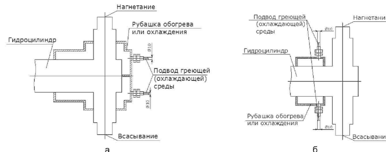
Рис.8.1 Варианты исполнения рубашки обогрева или охлаждения гидроцилиндра
